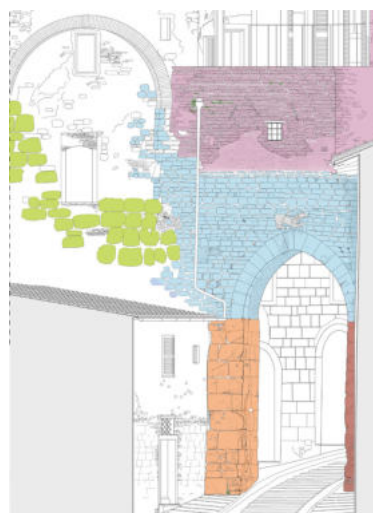
Fig. 1- Perugia, Porta Cornea, sono evidenziati: la spalla originaria (marrone scuro), quella ricostruita reimpiegando conci etruschi (marrone chiaro), in conci etruschi, i conci di un tratto di muratura etrusca (verde), i rifacimenti medievali (ciano) e le aggiunte successive laterizie da Radicioni et al. (2021).
