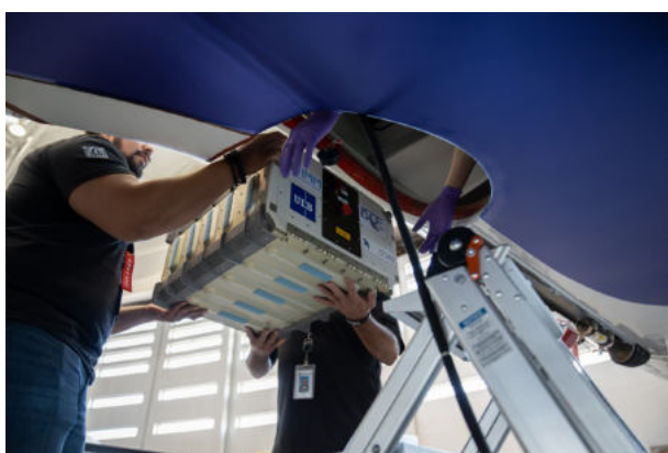
Fig. 7 - Inserimento nella spaceship del rack contenente la strumentazione dell'esperimento PING
