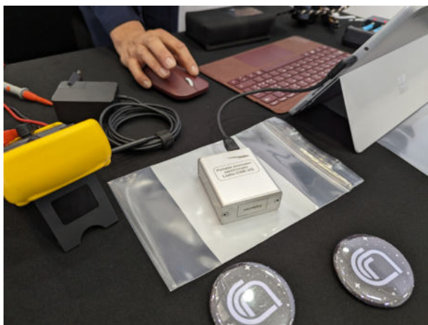
Fig. 5 - Il radiometro spettrometro dell'esperimento Liulin in grado di misurare i profili delle radiazioni cosmiche
