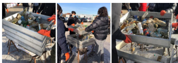
Fig. 3 - Sistema di setacci con maglie laterali di diverse dimensioni (200, 100, 80, 50 e 20 mm) utilizzato per l'analisi granulometrica
